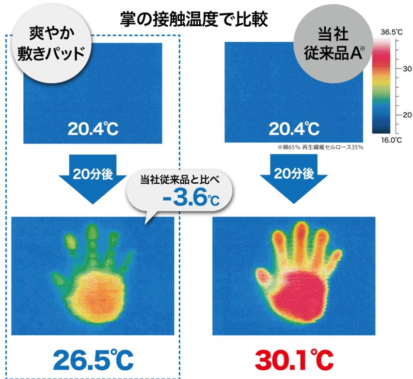
冷感比較試験：風速約3m/secの風を当て、生地に掌を20分間接触させ、初期、20分後の接触部分の生地表面温度をサーモグラフィを用いて撮影した。
